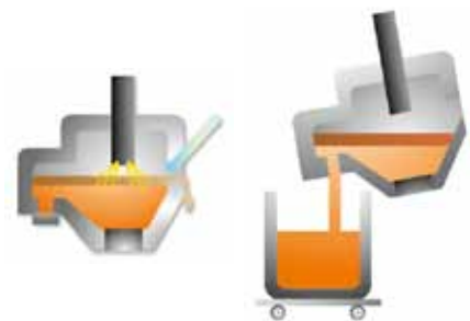
まず、表面の鋳滓を捨て(左)、次いで中部分の鉄を使う(右)
