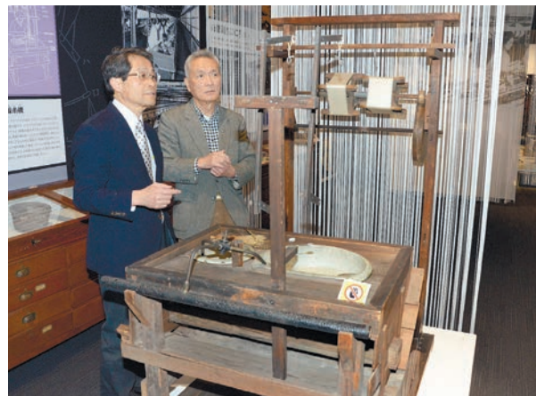
平野村(現岡谷市)で、製糸会社「中山社」を営む武居代次郎が開発した諏訪式繰糸機。フランス式とイタリア式を折衷した繰糸機で、比較的安価な機械でありながら高品質の生糸が生産できるとあって、明治期に全国に広がった
