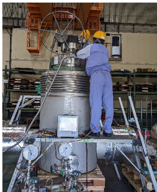
-253℃極低温の液化水素用大型ボールバルブ
