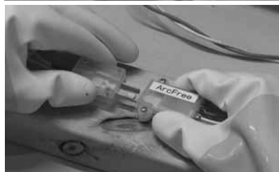
アーク放電するプラグ①と回路を組み込むことでアーク放電しないプラグ② （ソニーコンピュータサイエンス研究所提供）
