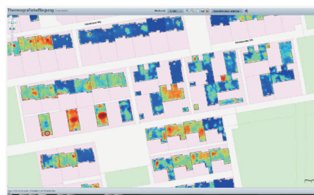
＜写真3＞建物からの熱の漏れを発見する航空写真の一例（市提供）
