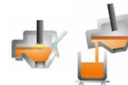
まず、表面の鉄滓を捨て（左）、次いで中の部分の鉄を俵う（右）
